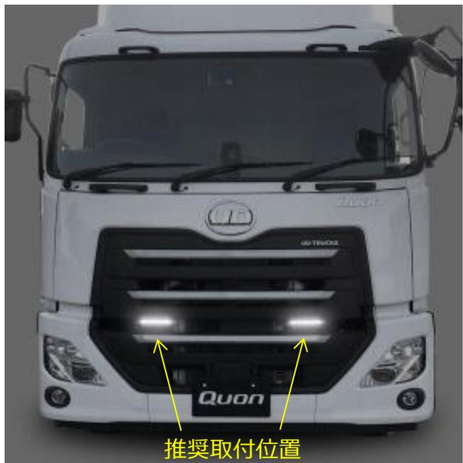
左図に示す推奨取付位置(フロントリッド下端部)へのハーネスキットA付属のブラケットAを使用したLEDエッジイルミのお取付けは下記をご参考に行なってください。
